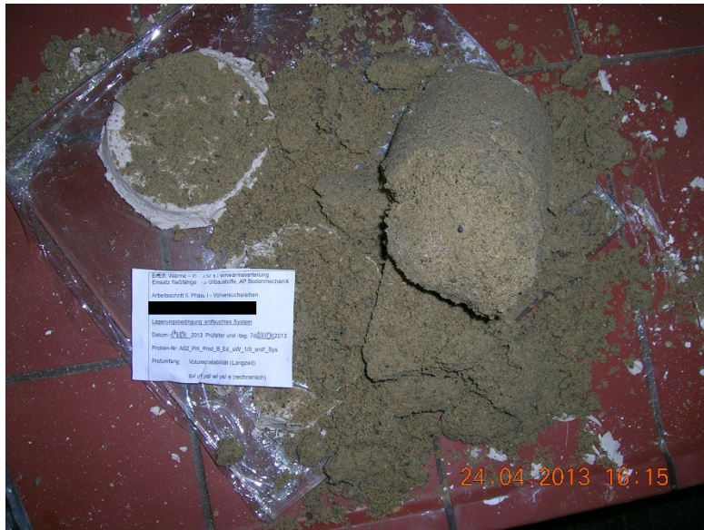
Abbildung 21: Produkt B – Beim Endflächenabgleich und durch leichten händischen Druck zerstörte Probe
