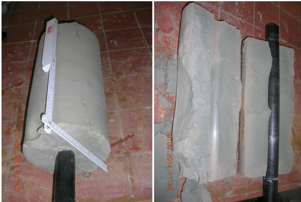
Abbildung 60: Produkt A – aus dem Re-SIST nach dem Versuch ausgebauter und zerlegter Probekörper
