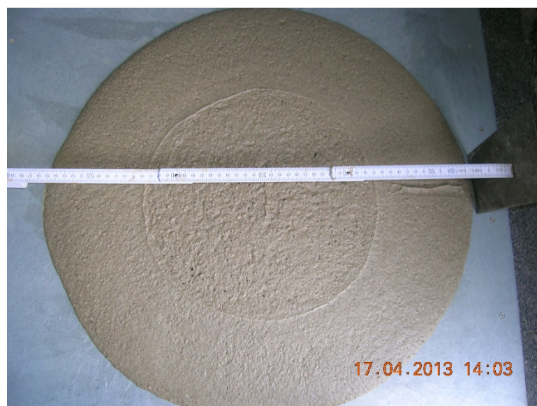
Abbildung 7: Produkt B – Prüfung Ausbreitmaß (Quelle: OTH.R, Labor für Geotechnik)
