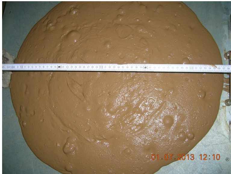
Abbildung 10: Produkt C-TL – Prüfung Ausbreitmaß (Quelle: OTH.R, Labor für Geotechnik)
