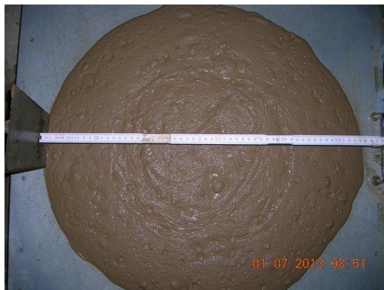
Abbildung 8: Produkt C-ST – Prüfung Ausbreitmaß (Quelle: OTH.R, Labor für Geotechnik)
