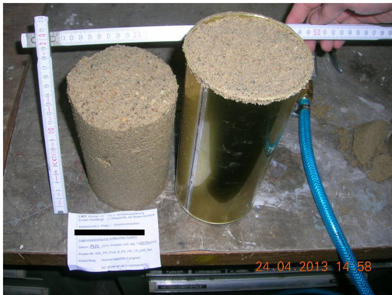
Abbildung 20: Produkt B – Alter 7 d, erdfeuchtes System – Misslungener Dosenabau
