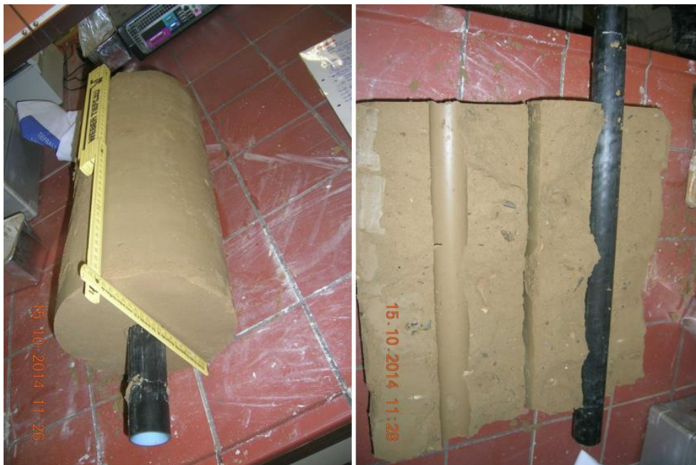
Abbildung 61: Produkt C-ST – aus dem Re-SIST nach dem Versuch ausgebauter und zerlegter Probekörper
