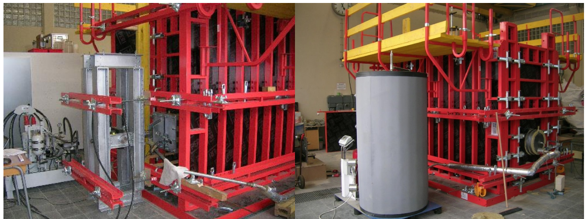
Abbildung 79: Hydraulische Presse mit Rohranschluss (links) und Heizungsanlage (rechts – Bildmitte) 1
