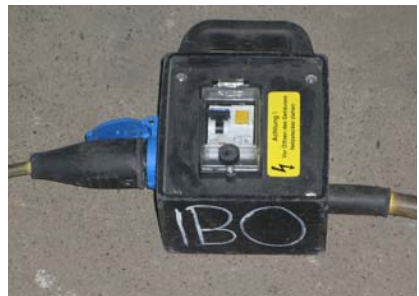
Abb. 9.2.4 Beispiel für eine vorgeschaltete Fehlerstromschutz- einrichtung mit separater Absicherung zum Einsatz in leitfähiger Um- gebung. Eine Verwendung in leitfähigen Bereichen mit begrenzter Bewegungsfreiheit ist nicht zulässig.
