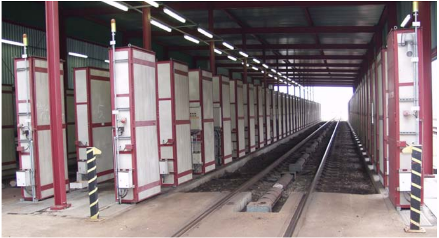
Abb. 12.3.1 Beispiel einer Auftauanlage mit gasbetriebenen Bodenbrennern sowie elektrisch betriebenen seitlichen Heizstrahlern
