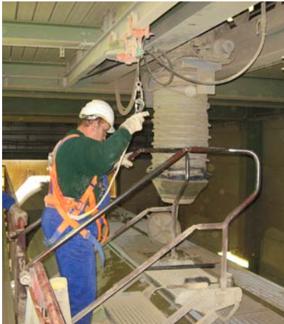
Abb. 12.1.3.1 Beispiel einer Zugangsbühne zum Besteigen von Silowaggonen. Ein Schienensystem verläuft an der Hallendecke in Zugfahrtrichtung.
