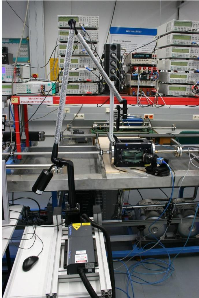
**Abbildung 14: Messaufbau mit SPIV-System und optischem Zugang**
