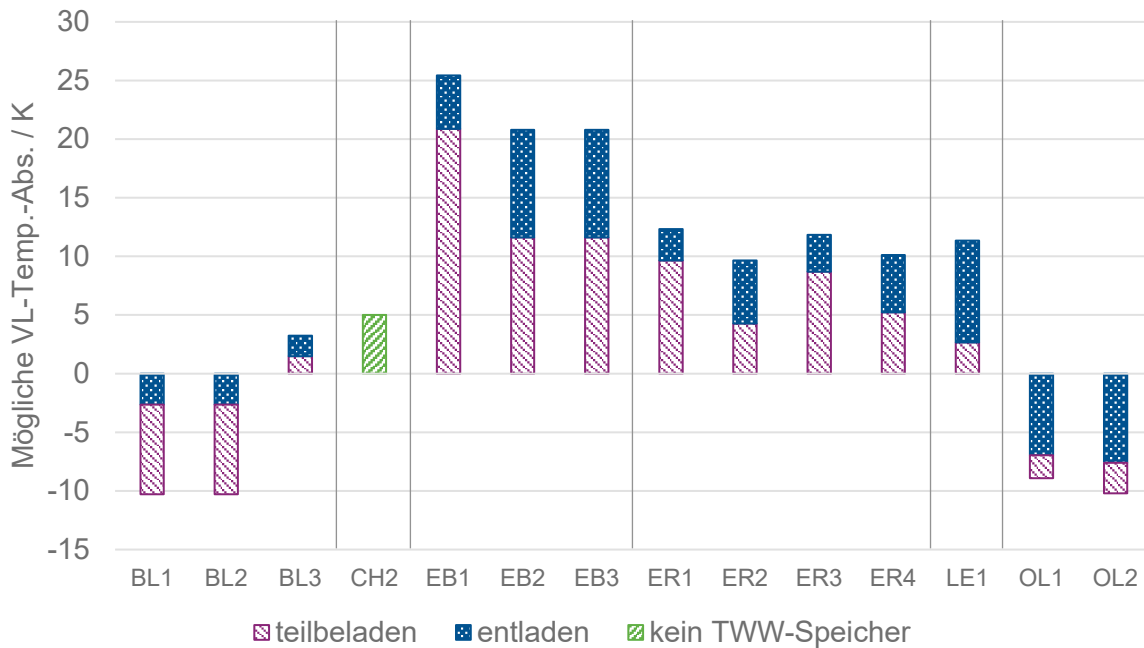
Abbildung 7-2: Mögliche VL-Temperaturabsenkung im Sommerlastfall
