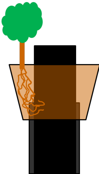
Abbildung 5: Versuchsaufbau zur Wurzelfestigkeit von KMR-Muffenverbindungen
